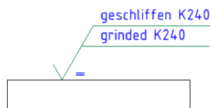
sich ergebende Schliffrichtung resulting grinding direction
