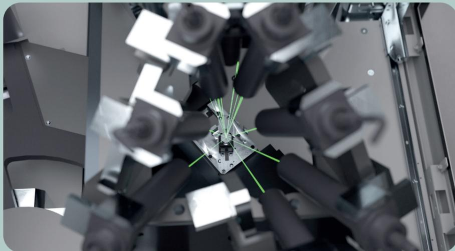
Selbstverständlich legen wir großen Wert auf saubere Produktionsbedingung. Aus diesem Grund ist unser active|alignment mit ESD-Equipment und einem Laminar-Flow-System (Reinraumausführung ISO 5) ausgestattet.
